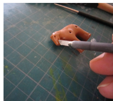
口などの直線的で深めの線刻はカッターで刻むと良いでしょう。
