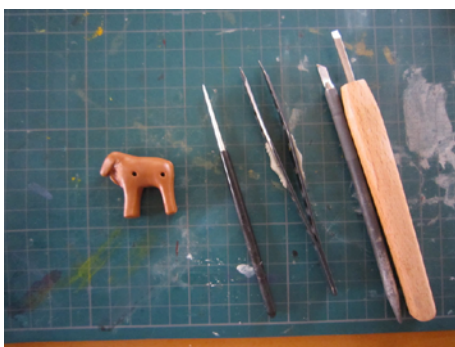
加工に使う道具です。右から平刃の彫刻刀、デザインナイフ、ピンセット、千枚通しです。
