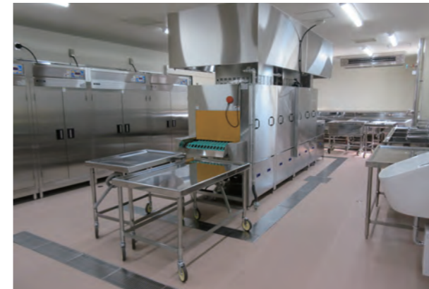
洗浄室 回収された食器・食缶・コンテナを洗浄する部屋です。
