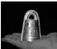
い温度で溶ける金属を溶かして型に注ぎ、手のひらサイズの銅鐸を作ります。
