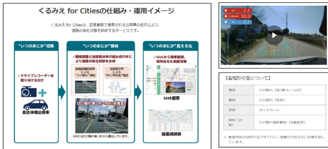
図－6.4 舗装定期点検における簡易路面調査（くるみえ等）
